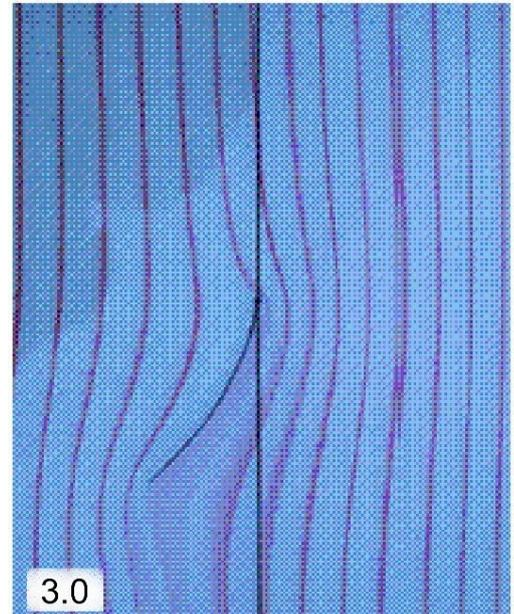
Se si tagliassero delle forme b-dimensionali su dei fogli opachi aventi lo stesso spessore del condotto, una volta introdotte e posizionate, le linee di colorante metterebbero in evidenza il comportamento del flusso intorno al corpo come si puo' notare sulla immagine 3.0. Il corpo opaco é solamente un filo di metallo piegato per simulare il profilo di una vela.
